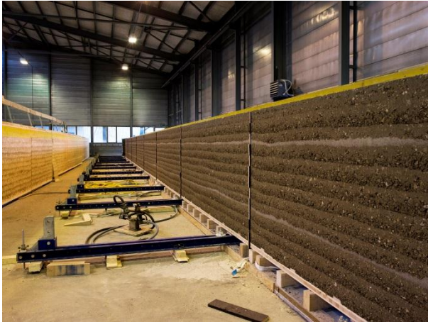
(Produktion Lehmwände Kräuterzentrum Ricola, Laufen, HdM, 2013 - )
